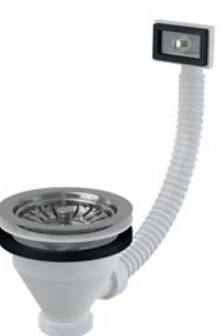
A38 Ventil chiuvetă 6/4" cu sită din oțel inoxidabil DN115 și preaplin flexibil
