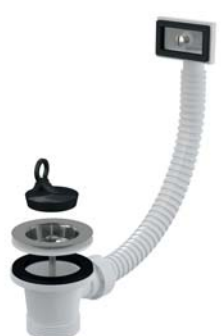
A331 Ventil chiuvetă 6/4" cu sită din oțel inoxidabil DN70 și preaplin flexibil spălat
