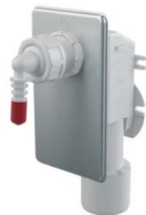
AKS7 Sifon încastrat pentru colectarea condensului, oțel inoxidabil DN40 și DN50
